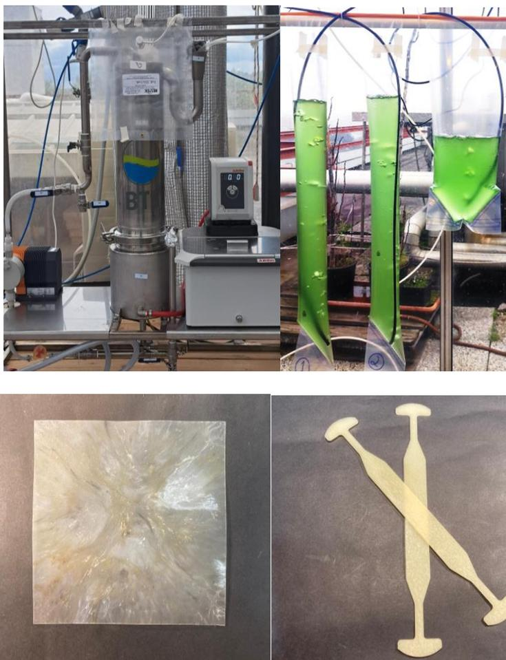
**Figura 2. Bioreattori e fotobioreattori utilizzati per la produzione di PHB con *C. necator* (in alto a sinistra) e *Synechocystis* sp. B12 (in alto a destra). I campioni di PHB prodotti all'UniPD sono stati testati come laminati (in basso a sinistra) e sono in fase di sviluppo applicazioni per il packaging (in basso a destra).**
