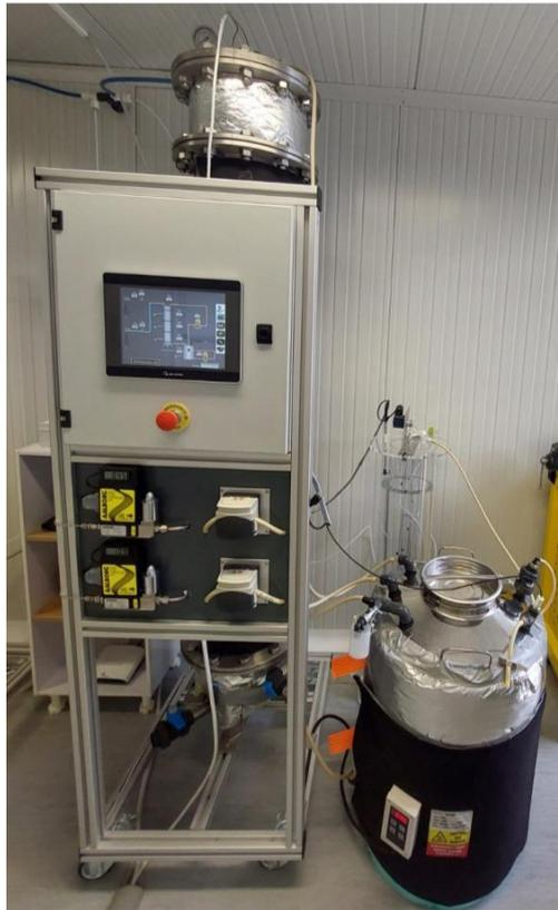
Figure 2. Impianto del bioreattore su scala pilota
