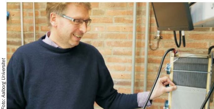
Lektor Torsten Berning fra Aalborg Universitet viser, hvordan plastikgitteret monteres foran brændselscellestakken.
