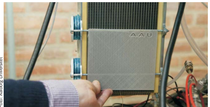
Et lille plastikgitter på 16 x 16 centimeter kan øge virkningsgraden for en brændselscelle med over 30 procent.
