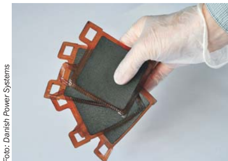
En håndfuld af de enkelte brændselsceller. Hver celle kan levere cirka 1 volt, så for at opnå en højere effekt samles cellerne i store stakke.
