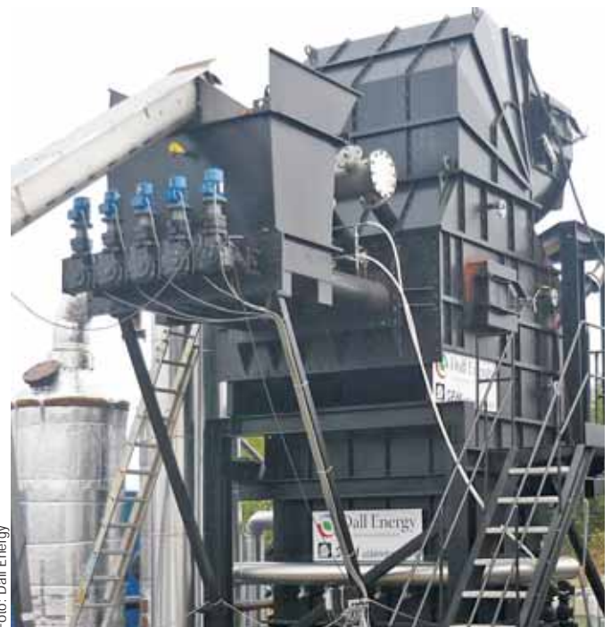
Dall Energys biomasseovn med befugtninganlæg.
