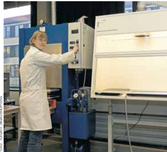
Produktionschef Carina Therkelsen har netop lagt en MEA ind i en varmepresser.
