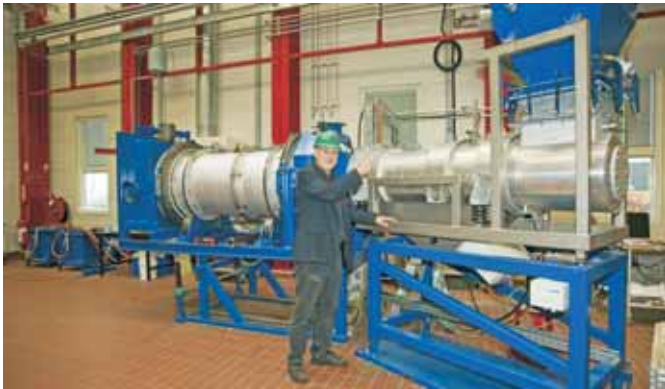
Peter Arendt Jensen ved siden af roterovnen, der er blevet brugt til at forbedre bundasken fra affaldsanlæg.
