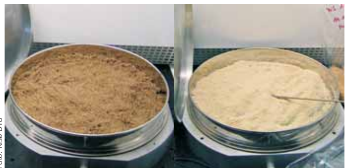
Hvedehalm henholdsvis før (til venstre) og efter plasma-behandling (til højre).
