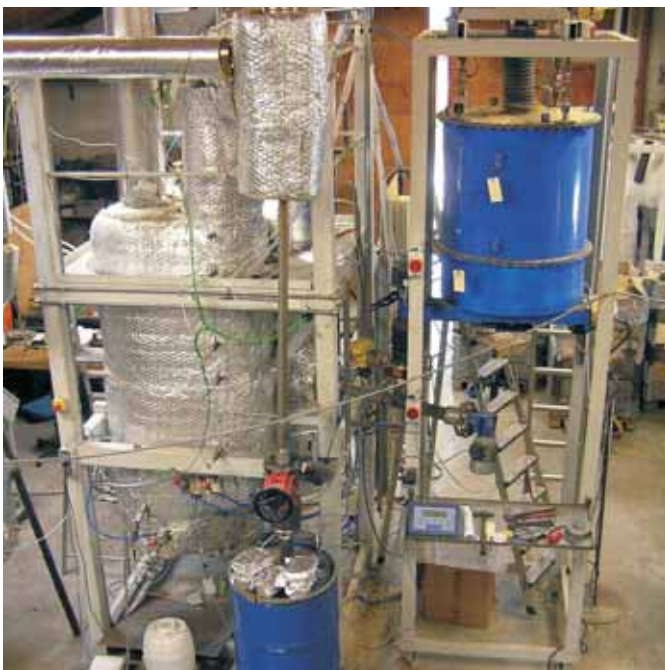
Det nye 100 kW forsøgsanlæg, der blandt andet er blevet brugt til en række vellykkede forsøg med halm samt restfibre fra CP-Kelco.
