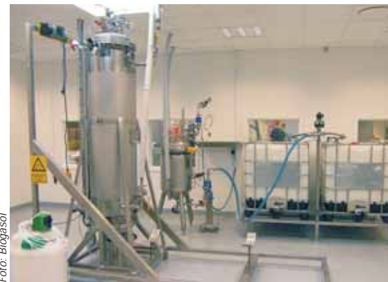
BioGasols fermenteringsreaktor til C5 sukker.
