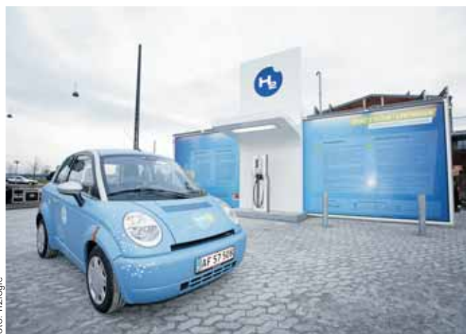
Brintbil og tankstation i København. Tankstationen blev oprindeligt designet til at kunne levere et tryk på 300 bar, men er senere opgraderet til et tryk på 700 bar.
