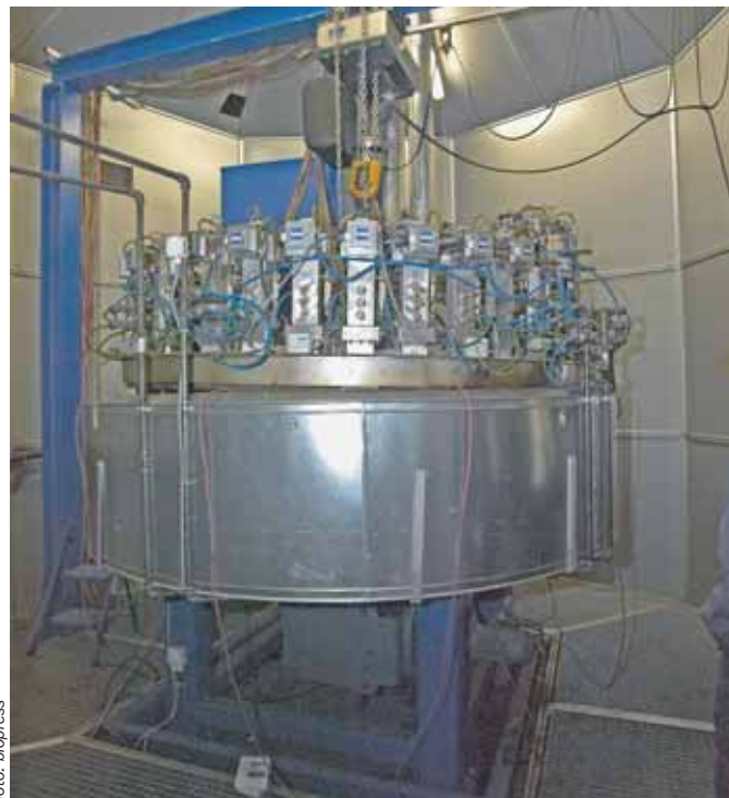
Den cylinderformede reaktor med de specielle elektronrør, magnetroner, der sender mikrobølger ned gennem halmen. Anlægget kan producere 40 – 50 liter olie i timen.
