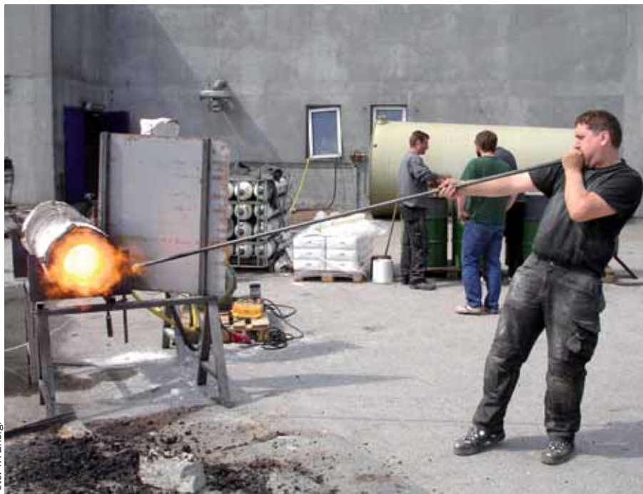
Afprøvning af mindre forsøgsanlæg til forgasning af affald hos TK Energi i Køge. På billedet er man ved at teste den slagge, som anlægget producerer.
