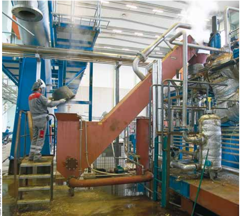
På Skærbækværket ved Fredericia er DONG Energy langt fremme med udvikling af en teknologi, der gør det muligt at udvinde ethanol af halm og bruge restproduktet som brændsel.
