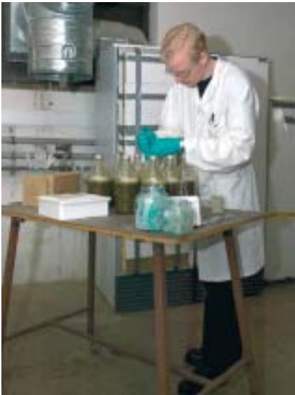
Studerende Verner Holm udfører forsøg med tilsætning af enzymer for at fremme gasproduktionen.
