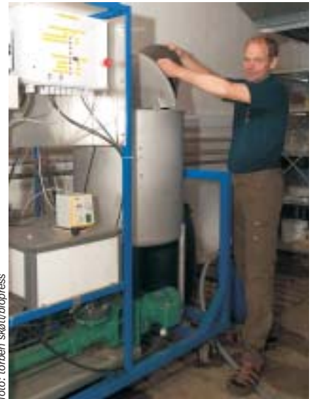
Henrik B. Møller hælder gylle i fontanen til en af de fire forsøgsreaktorer på gyllelaboratoriet.
