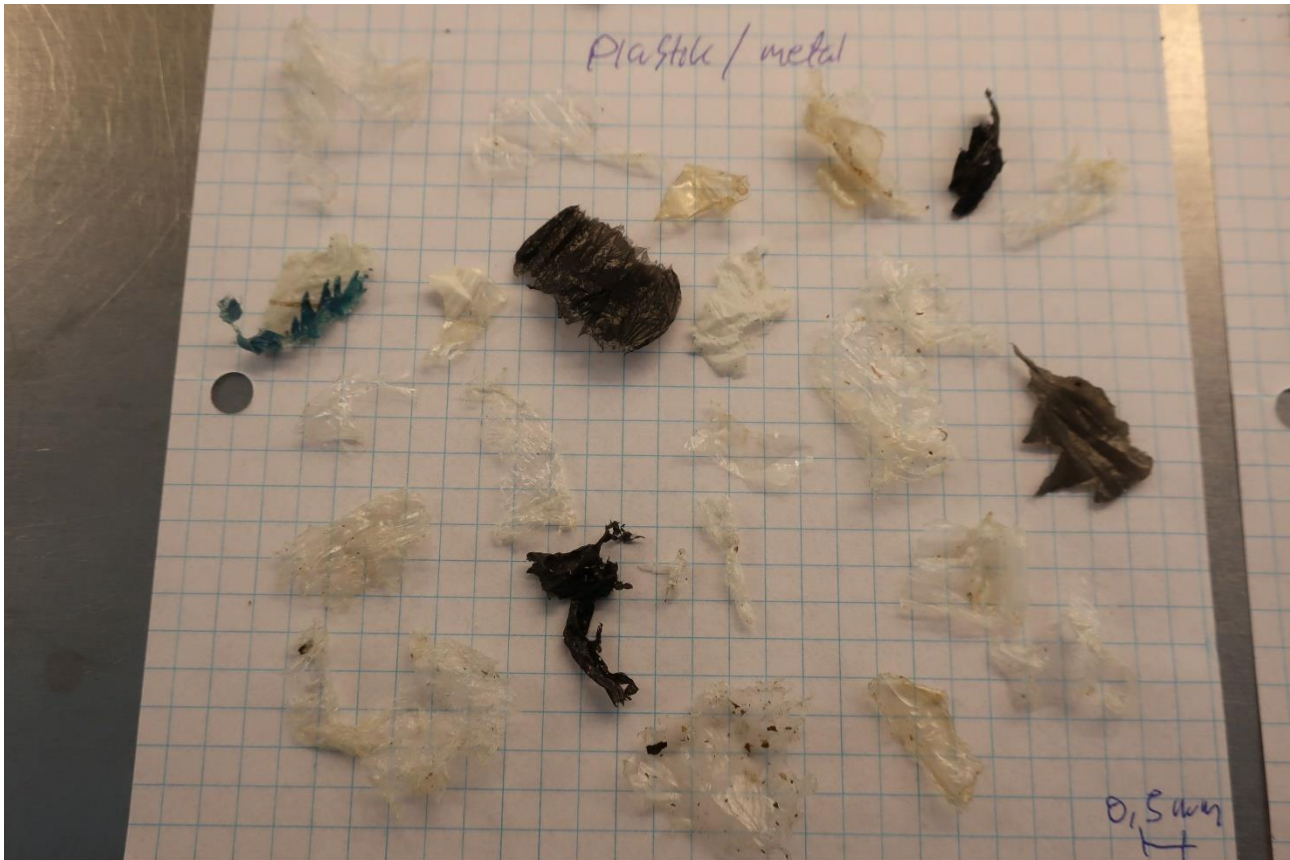
LB analyse af pulp fra Dewaster prøve 19-04-2018 nr 2 - andel af plast og metal over 8 mm, 04.05.2018, kl. 11:34
