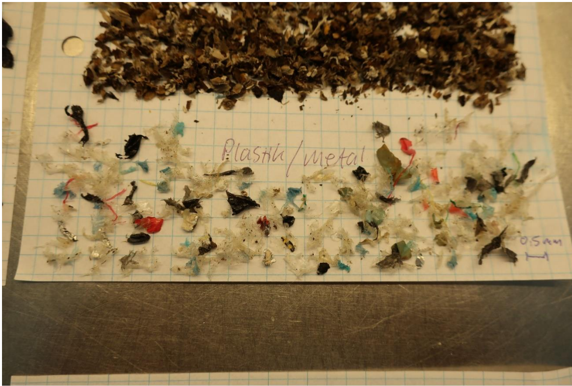
LB analyse af pulp fra Dewaster prøve 19-04-2018 nr 1 - andel af plast og metal 2-4 mm, 04.05.2018, kl. 11:33
