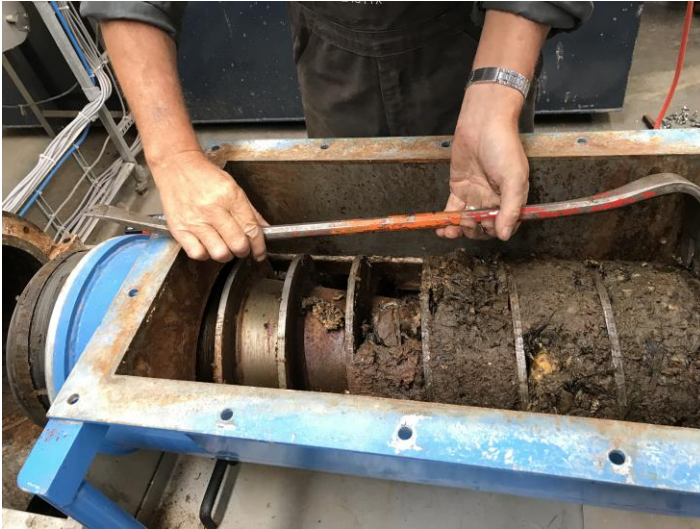
Billed 10: Kig ind i Dewaster sneglen ved test
