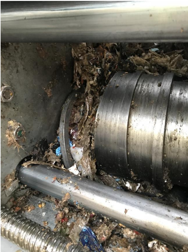
Billed 8: Her ses at forringsring er beskadiget fra sidste test og den begynder at gå gennem systemet.
