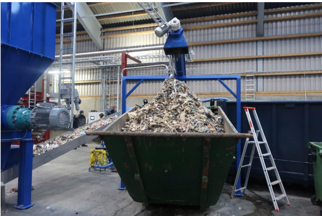
Billed 3: Reject ledes til container og biopulp pumpes til anden container
