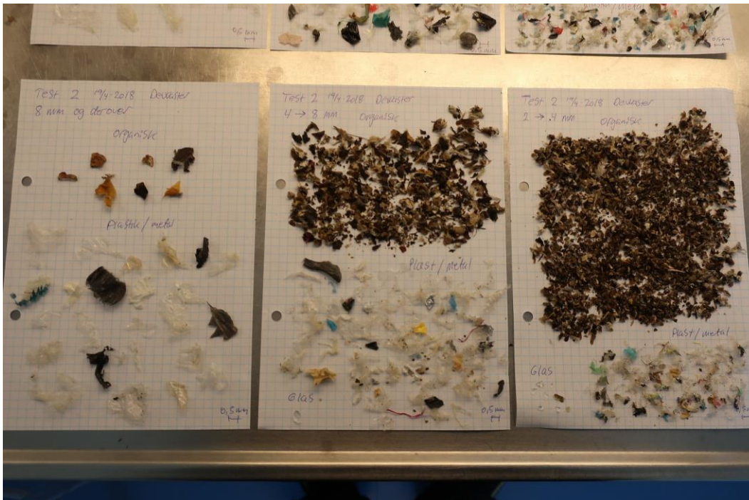
Billed 13: Egenkontrol af urenheder over 2 mm i biopulp
