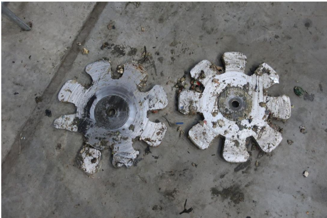
Billed 7: Ødelagt pressehjul
