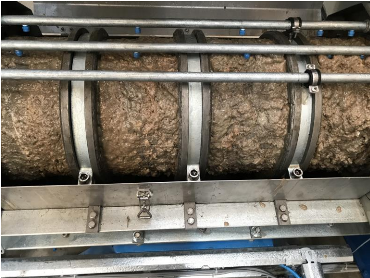
Billed 4: Tilstoppet materiale i presse
