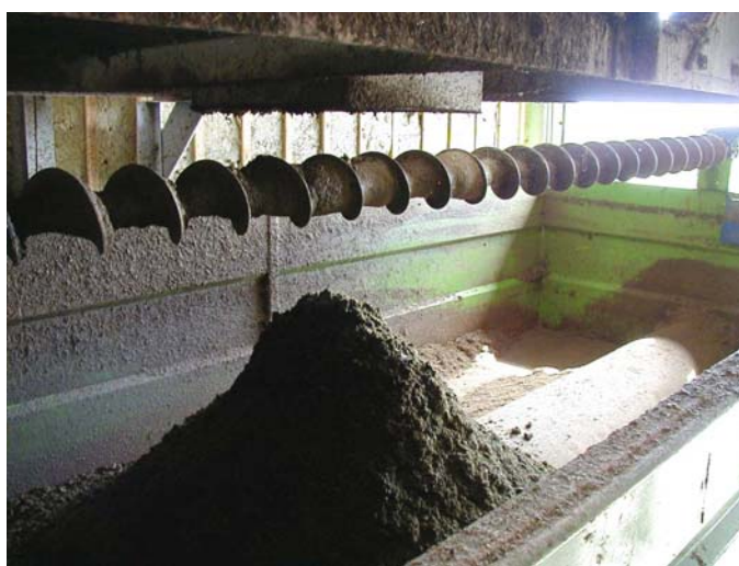
Figura 6.5. Container de colectare a fibrelor, cu melc de distribuție (ANGELIDAKI, 2005)
