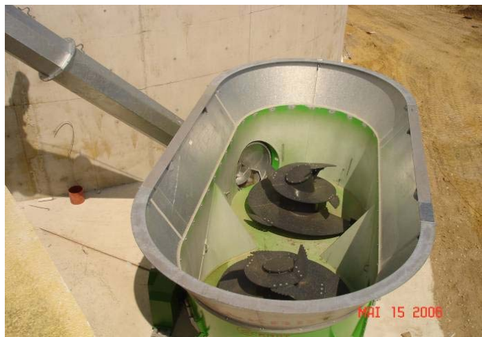
Figura 7.14. Container de alimentare pentru material însilozat (AGRINZ GmbH, 2006)
