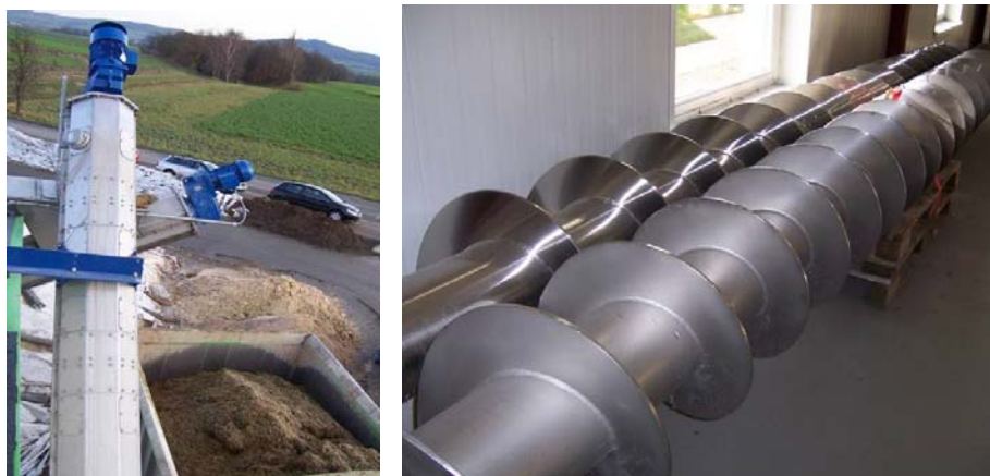
Figura 7.12. Sistem de transport tip conductă cu melc rotativ (stânga) și melci rotativi, pregătiți pentru instalare (dreapta) (RUTZ, 2007)
