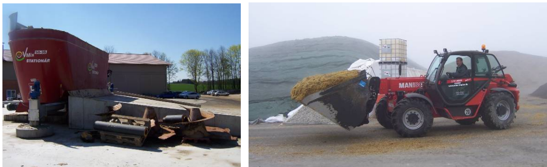
Figura 7.10. Sistem de alimentare al containerului pentru materii prime solide: porumb însilozat și gunoi solid de pasăre (stânga) și încărcător cu porumb însilozat (dreapta) (RUTZ, 2008)
