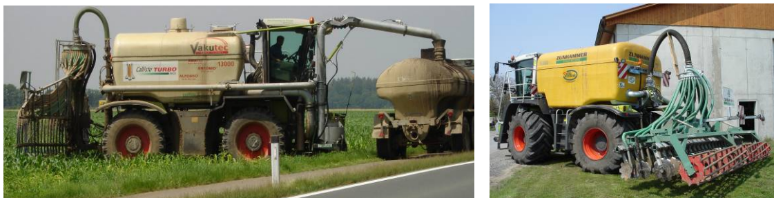
Figura 6.3. Vehicule folosite la aplicarea digestatului ca îngrășământ, prin utilizarea pompelor de sucțiune cu furtun (AGRINZ GmbH)
