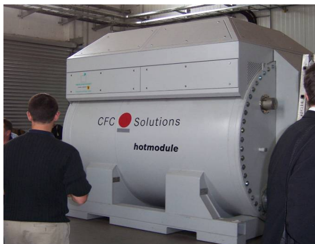
Figura 5.6. Prima pilă de combustie MCFC pentru biogaz din lume, funcționând în Germania (RUTZ, 2007)
