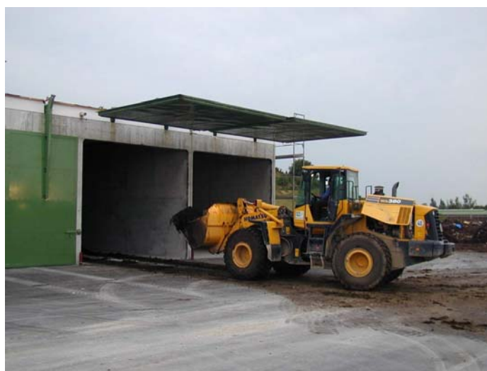
Figura 7.18. Digestor cu funcționare discontinuă de tip garaj, încărcat cu ajutorul buldozerului (BEKON, 2004)
