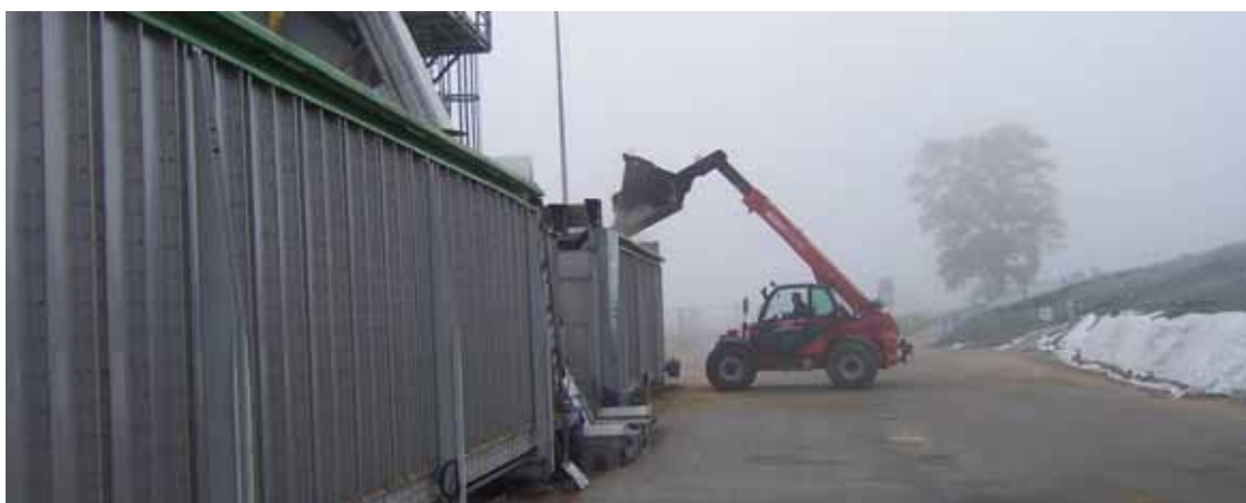
Slika 7.11. Utovarivač puni spremnik (kontejner) kukuruznom silažom
