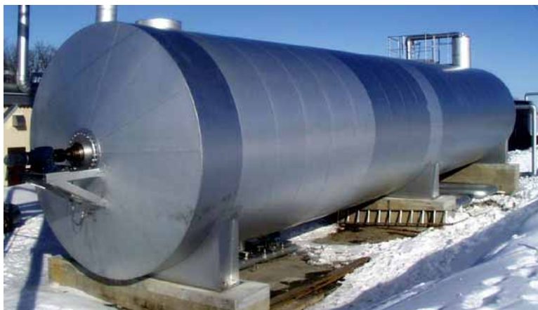
Slika 4.3. Horizontalni digester izrađen u Danskoj
