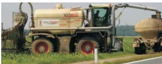
Slika 6.3. Vozila za nanos presnovljenega substrata kot gnojilo, ki uporabljajo vlečne dragging cevi. Vir: Agrinz, 2008
