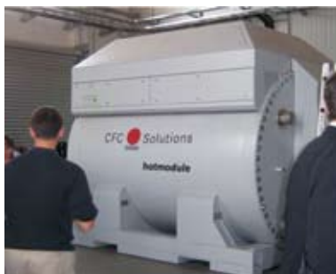
Slika 5.5. Prva gorivna celica stopljenega karbonata za bioplin na svetu deluje v Nemčiji. Vir: D. Rutz, 2007
