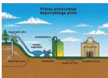
Slika 4.12. Sistem za rekuperacijo plina na odlagališču. Vir: NST Engineers, 2007.
