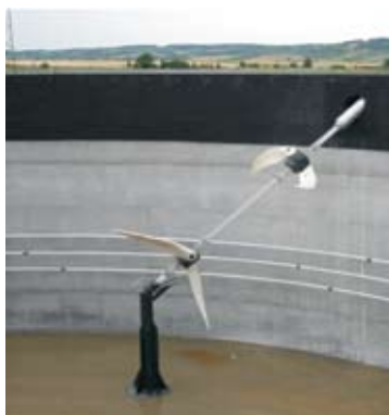
Slika 7.24. Lopatični mešalnik. Vir: AGRINZ, 2006
