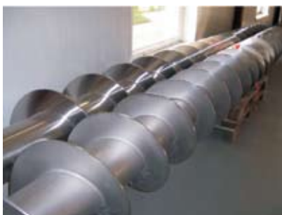
Slika 7.12. Transportni sistem cevi s polžem (levo) in polžni transporterji, pripravljeni za namestitvev (desno). Vir: RUTZ 2007
