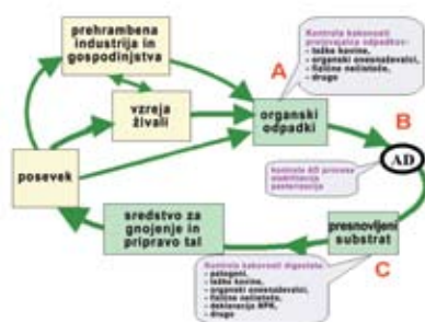
Slika 4.9. Shematični prikaz zaprtega kroga centralizirane anaerobne digestije (AD). Vir: T. Al Seadi, 2003.
