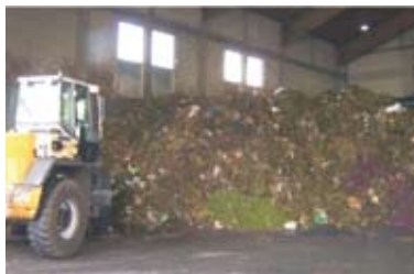
Slika 3.1. Trdni komunalni odpadki, pripeljani v bioplinsko napravo v Nemčiji. Vir: D. Rutz
