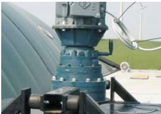
Slika 7.23. Viseči lopatični mešalnik (levo) in njegov motor (desno). Vir: AGRINZ, 2006
