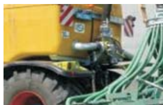
Slika 6.3. Vozila za nanos presnovljenega substrata kot gnojilo, ki uporabljajo vlečne dragging cevi. Vir: Agrinz, 2008
