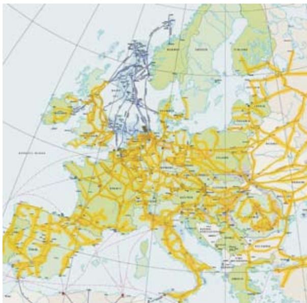
Slika 2.1. Evropski plinovod z zemeljskim plinom in potencialni koridorji (rumena), primerni za proizvodnjo bioplina in dovod biometana. Vir: Thrän D., Seiffert M., Müller-Langer F., Plättner A., Vogel A. (2007)
