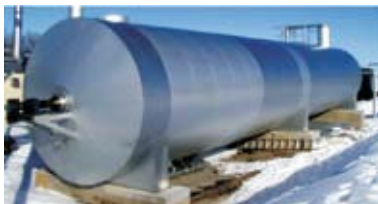
Slika 4.3. Horizontalen digestor izdelan na Danskem. Vir: Nordisk Folkecenter, 2001
