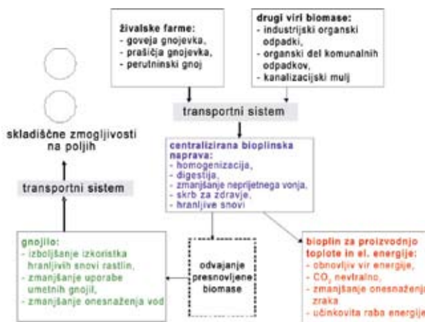
Slika 4.10. Glavne usmeritve integriranih konceptov centraliziranih naprav s sočasno presnovo. Vir: S. Tafdrup, 1994 and T. Al Seadi 2003.
